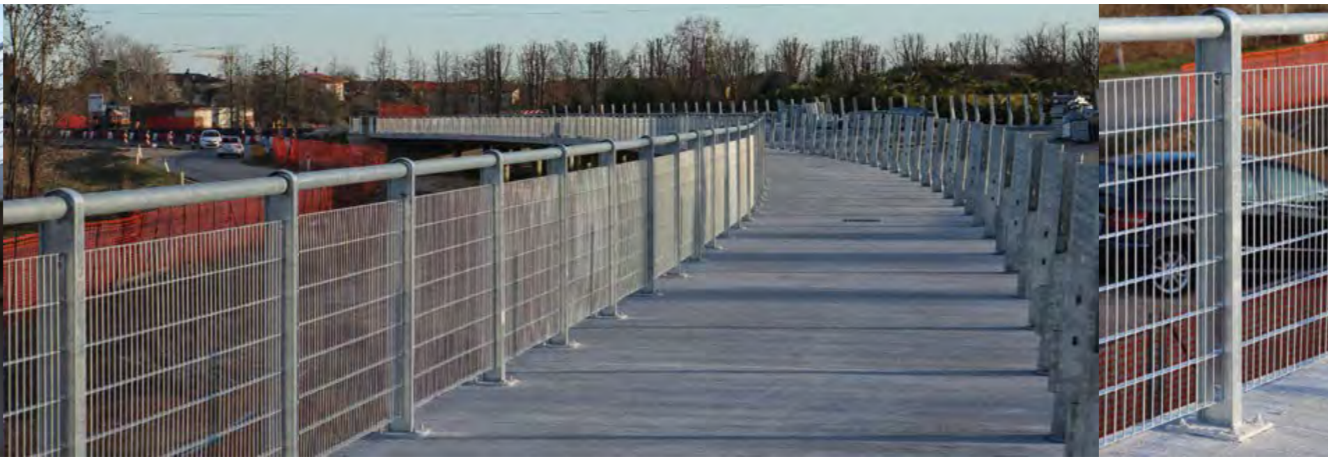
RECINZIONE DI SICUREZZA PER CAVALCAVIA Grigliato Elettrofuso tipo Baldassar M. 62x66 mm P. 25x3 mm , "QUASAR" acciaio S235JR. Collegamento con tondo liscio Ø5mm bordato, zincato a caldo secondo norme UNI EN ISO 1461 e verniciato a polveri RAL 6005.
