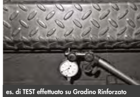
es. di TEST effettuato su Gradino Rinforzato
