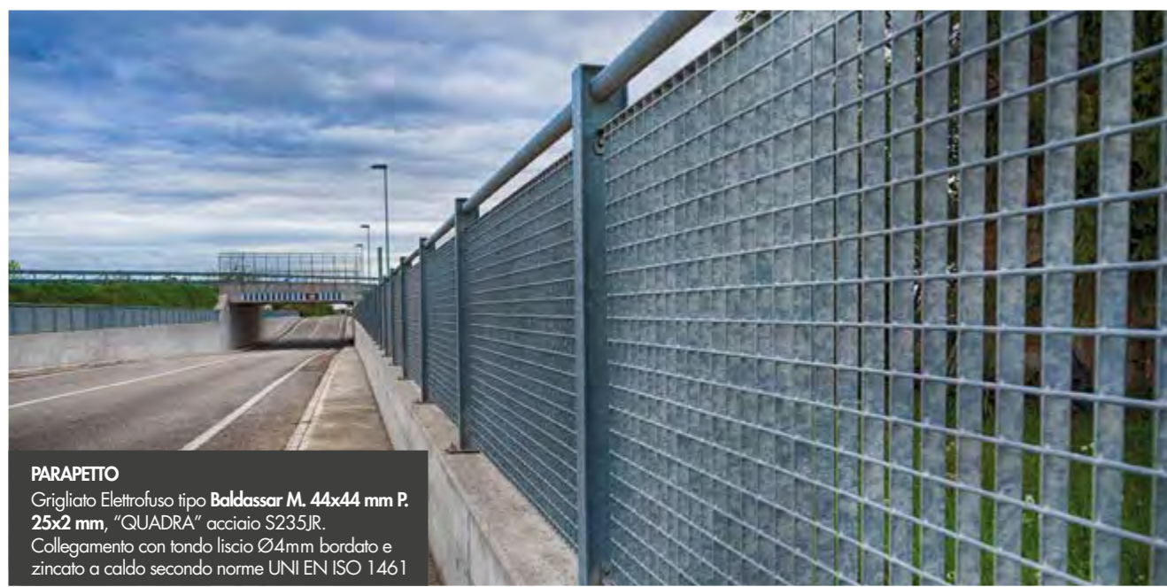
RECINZIONE DI SICUREZZA PER CAVALCAVIA Grigliato Elettrofuso tipo Baldassar M. 44x44 mm P. 25x2 mm , "QUADRA" acciaio S235JR. Collegamento con tondo liscio Ø4mm bordato e zincato a caldo secondo norme UNI EN ISO 1461
