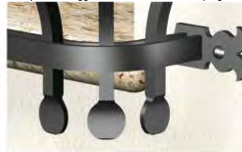
Esempio di fissaggio traversali di inferriata sporgente
