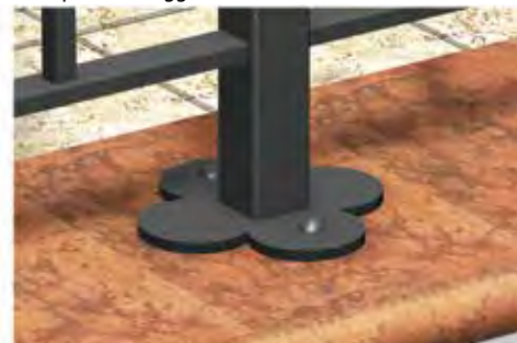
Esempio di fissaggio montante di recinzione
