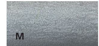
Metallisation arcspray process Metallizzato
